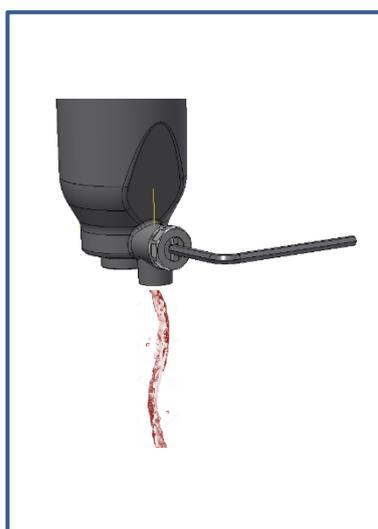
Ouvrir l'évacuation. La saleté à l'intérieur du filtre qui n'est plus attirée par l'aimant sera entraînée à l'extérieur par le flux d'eau qui s'écoule. Utiliser un récipient de collecte d'une capacité d'au moins 1 l.
